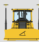
Dubbele GNSS- en hellingcontrole
