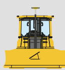
Enkele GNSS- en hellingcontrole
